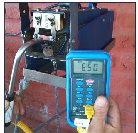
Пирометр показывает соответствующую температуру - 650°C.
